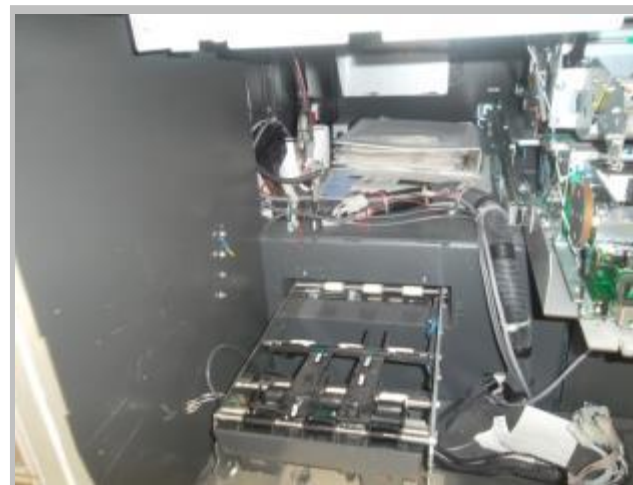
EFFRAZIONE DA ESTERNO PER ATTACCO A CASSETTO SUPERIORE
